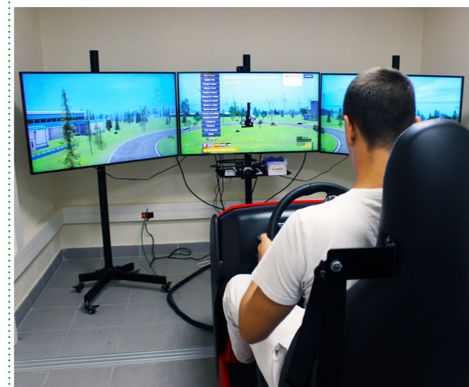
Simulateur de conduite automobile, matériel-phare de ce financement, permet l'évaluation de la capacité à reconduire après une pathologie neurologique ou locomotrice et de développer les compétences en matière de conduite automobile du patient en toute sécurité. Il offre une expérience de conduite réaliste et personnalisée ainsi que la possibilité d'ajuster le niveau de difficulté pour s'adapter à leur déficit. Equipé de plusieurs modules comme la présentation d'obstacle, il évalue et rééduque la rapidité et les réflexes moteurs et cognitifs et propose un véhicule futur adapté à leur besoin (vitesse automatique, commande sur le volant...)
